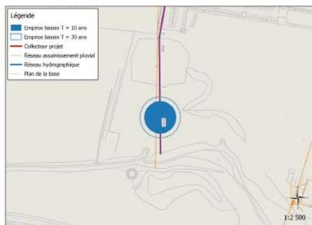
Figure 15 : Dimensionnement du bassin pluvial n°2 (rapport PRO ; SAFEGE)
